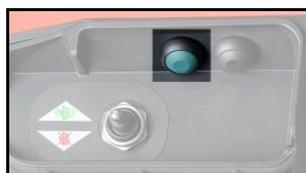
La radio opérationnelle, chaque appui sur le bouton vert fera retentir le klaxon du véhicule.
