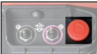
Un appui sur l'arrêt d'urgence mettra votre radio commande hors fonctions.
