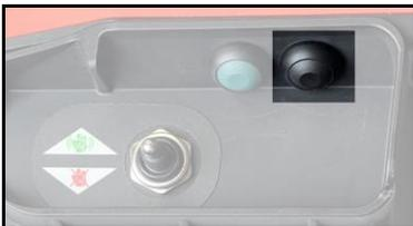
Le débrayage du treuil ne peut s'effectuer que si appui sur le bouton noir côté gauche pendant l'abaissement du commutateur
