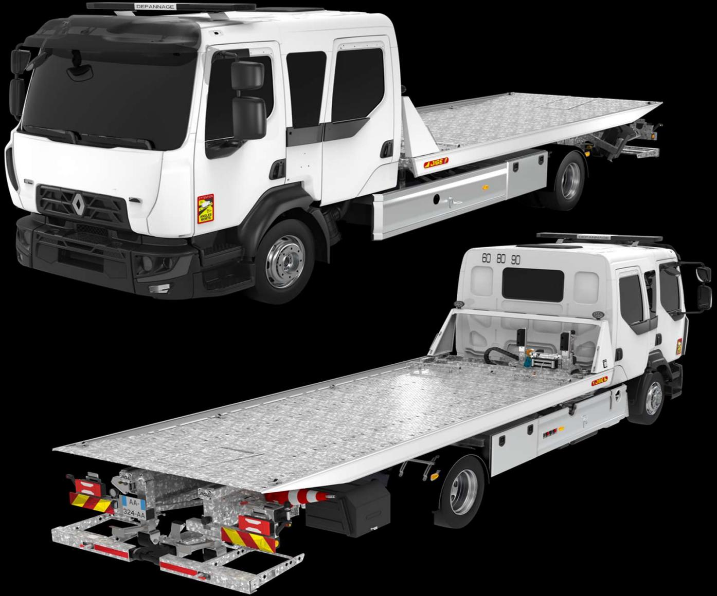
Châssis cabine RENAULT D13 PTC 12T ayant un empattement de 5300mm, cabine double.
