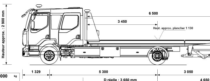
13 000 P.T.C / G.V.W. 9 400 Poids de la Dépanneuse kg Wrecker weight 3600 Charge utile kg Payload Poids châssis à vide 5 582 Chassis cab weight Poids équipement 3 843 kg Equipment weight Nombre de passagers 7 Number passengers Hauteur châssis route (mm) 886 Largeur flancs pneumatiques 2 384 arrière (mm) Longueur X Largeur (hors tout) (mm) Overal width x Overal length 9 859 X 2 400
