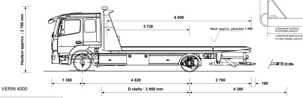
850 mm Hauteur châssis route Largeur flancs 2 325 mm pneumatiques arrière 11 990 kg P.T.C / G.V.W. Poids châssis cabine à vide 4 735 kg Chassis cab weight Nombre de passagers 6 Number passengers Largeur hors tout 2 400 mm Overal width Longueur hors tout 9 160 mm Oeral length 3 331 kg Charge utile
