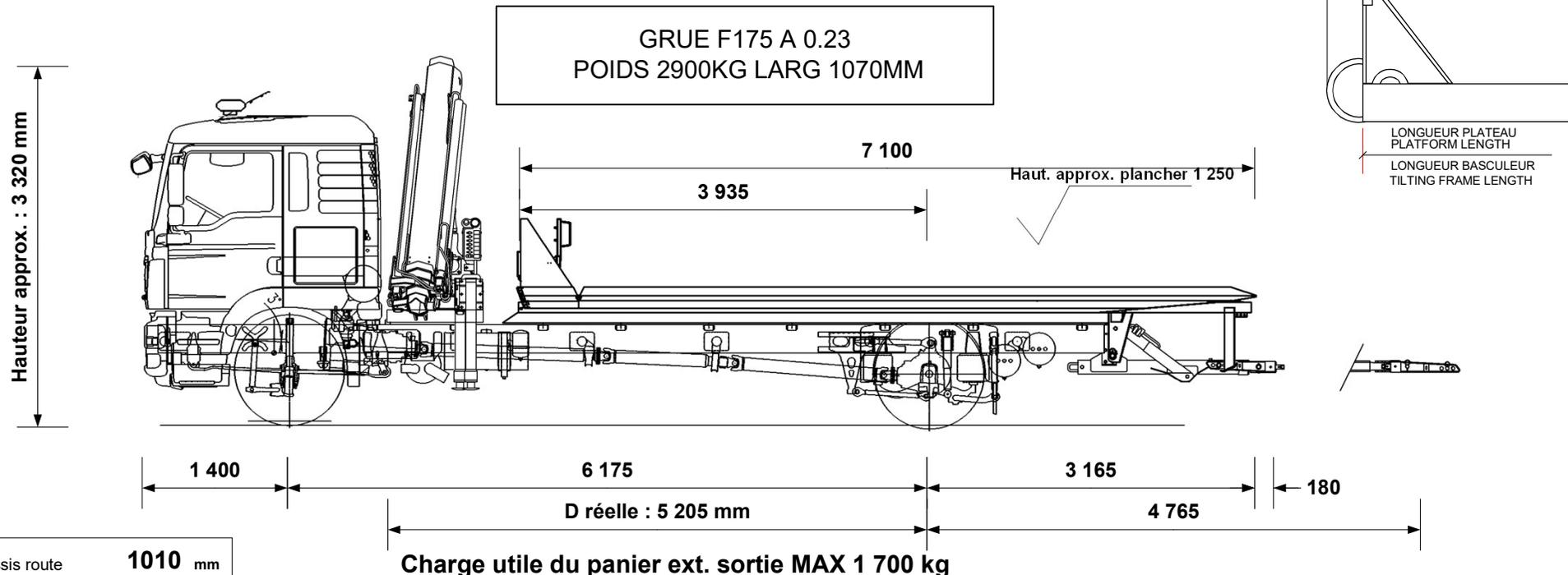
**Charge utile du panier ext. sortie MAX 1 700 kg**
