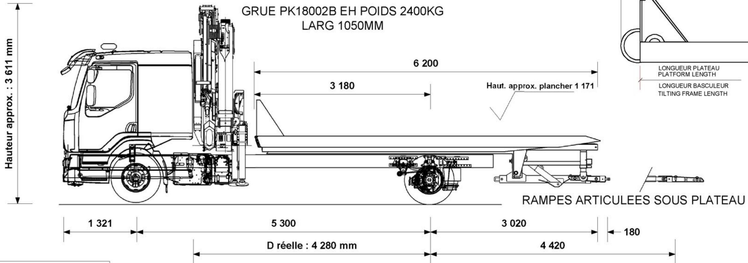
**Charge utile du panier ext. sortie MAX 1 700 kg**
