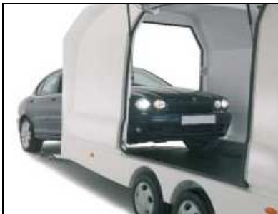
Visibilité totale durant la phase de chargement d'un véhicule / Portes papillons latérales facilitant la montée et descente du véhicule Portes latérales avant facilitant la mise en place des sangles de maintien
