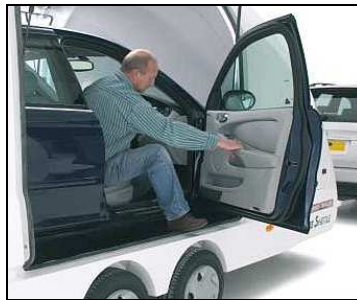
Visibilité totale durant la phase de chargement d'un véhicule / Portes papillons latérales facilitant la montée et descente du véhicule Portes latérales avant facilitant la mise en place des sangles de maintien
